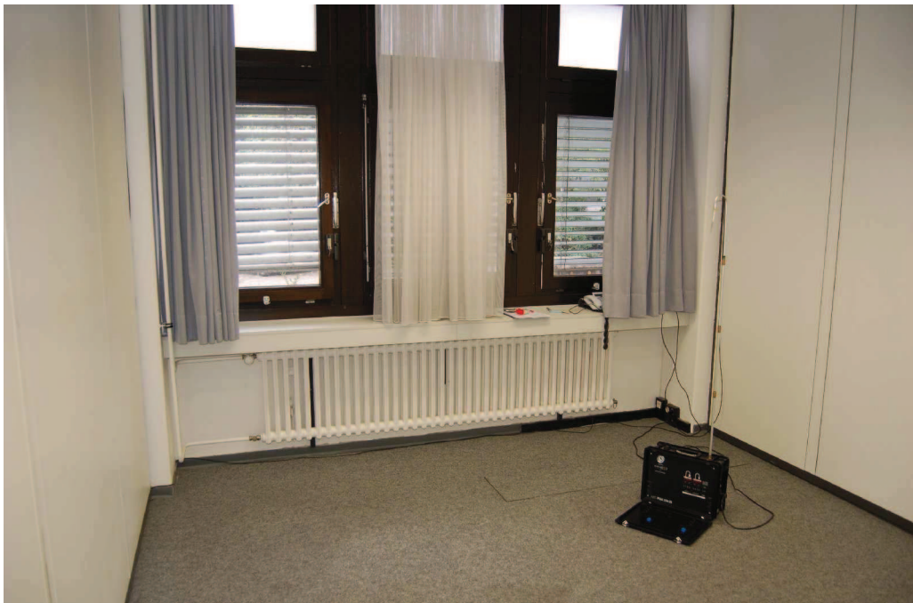
Bild 3/4: Raum 421, Übersichtsaufnahmen, es wurde eine Messung auf PCP/Lindan, Formaldehyd und PCB (Polychlorierte Biphenyle) durchgeführt.
